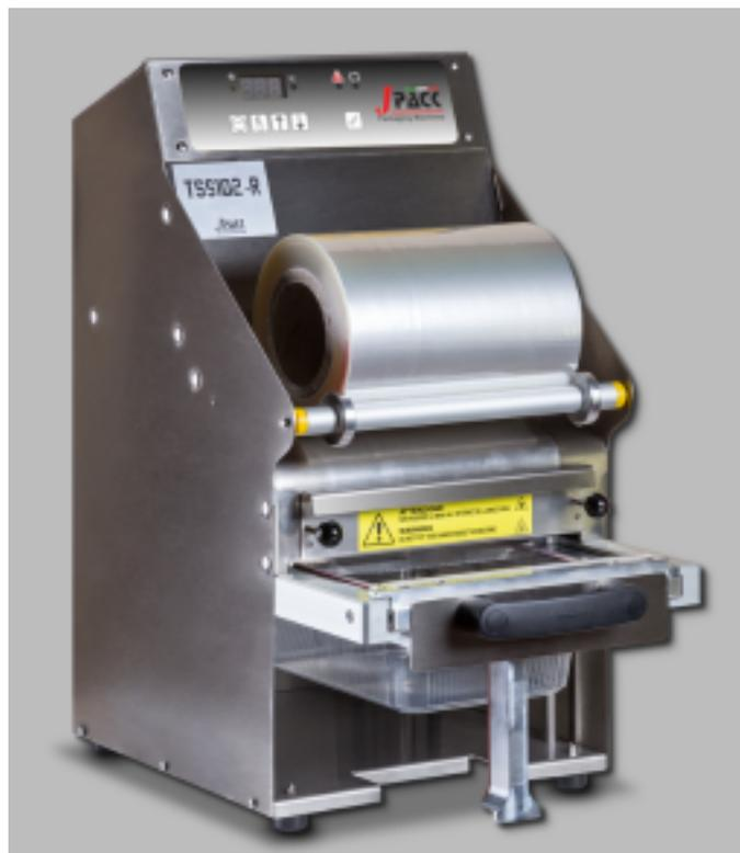
Stampo regolabile: gli stampi regolabili permettono di confezionare fino a 16 tipi diversi di vaschette in termini di dimensioni e profondità, questa versatilità unica nel suo genere permette di avere una macchina per tutti gli usi soprattutto in situazioni come il delivery che richiede velocità di esecuzione ed estrema flessibilità
